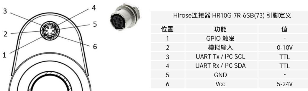
图 7: 带嵌入式控制器 ECC-1C 的镜头型号的电气连接，配备（母头）Hirose 连接器。
