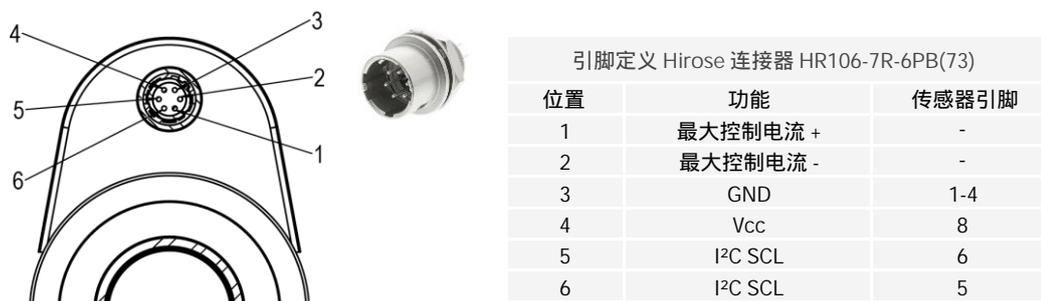
图 6: 无嵌入式控制器的镜头型号的电气连接，配备（公头）Hirose 连接器。
